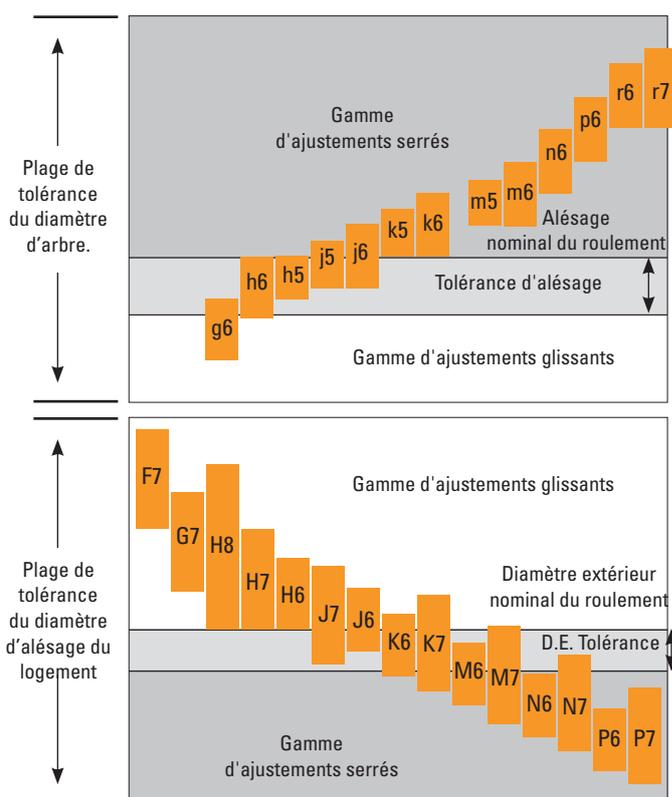
Figure 5. Sélection d'ajustement pour l'arbre et le logement.
