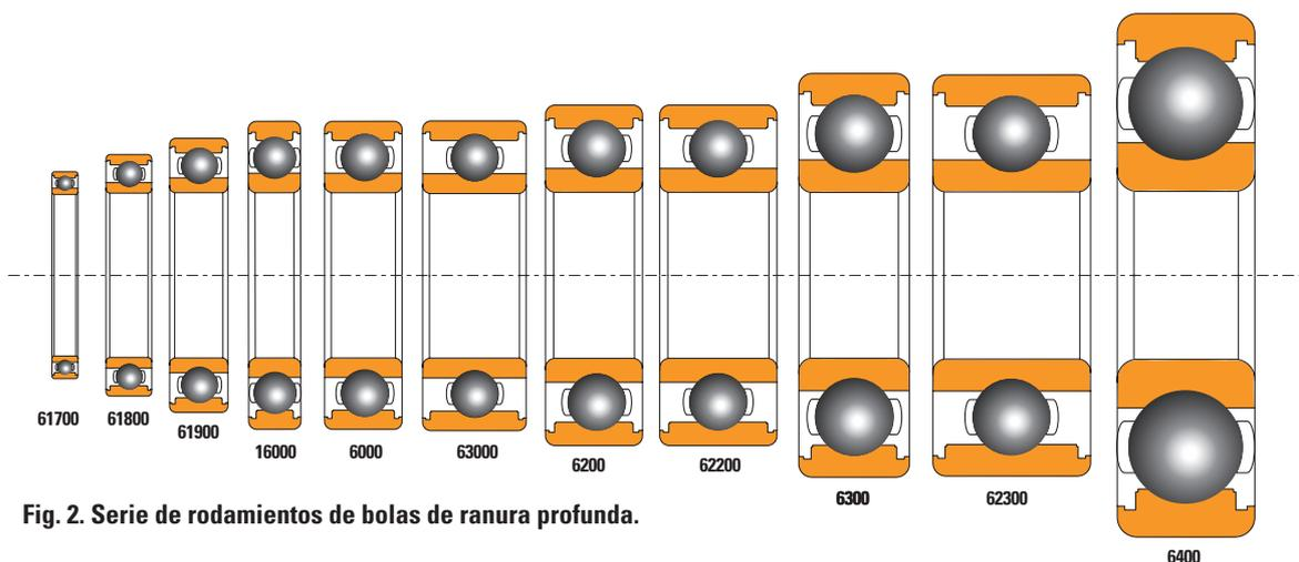
Fig. 2. Serie de rodamientos de bolas de ranura profunda.
