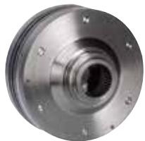
TLC限矩器设计旨在消除冲击载荷。它能吸收转子的动能，并通过打滑来保持设置好的扭矩值。我们限矩器的专利设计使得扭矩设定值可以防止篡改，并消除了因人工误调而造成的问题。
