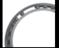
Rulman kilitlemesinden dolayı kafes hasarı
