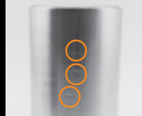
Kötü taşımaktan dolayı oluşabilecek ezikler ve göçükler
