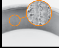
Elektrik kıvılcımı oluklanması
