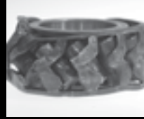
Aşırı sıcaklık üretiminden dolayı bilezik deformasyonu
