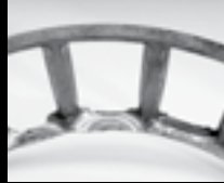
Düzensiz yoğun makara hareketinden dolayı Kafes cebinde aşınma
