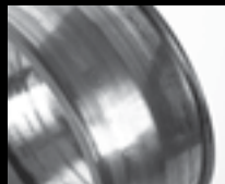
Rulman iç bileziğinde sivama aşınması
