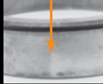
İki parçalı yataklarda yatak birleşim noktasındaki çap farkının etkisi ile oluşan iz
