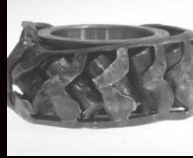
Aşırı sıcaklık üretiminden dolayı bilezik deformasyonu
