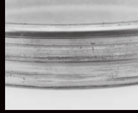
Bir tekerlek poyrasına takılmış gevşek dış halka
