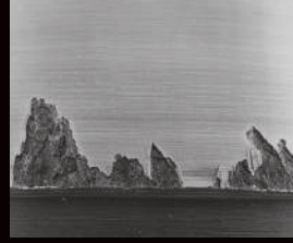
Yuvarlanma yüzeyinin sağında veya solunda oluşan Bölgesel Yüzey Karıncalanması (BYK)
