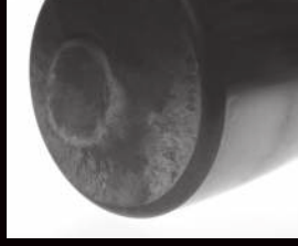
Ağır aşınmaya maruz kalarak deforme olan makara ucu
