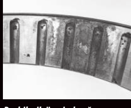
Dış bilezik üzerinde ağır makara aşındırma izleri
