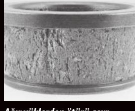
Ağır yüklerden ötürü aşırı soyulma ve kabarma
