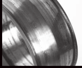
Rulman iç bileziğinde sivama aşınması
