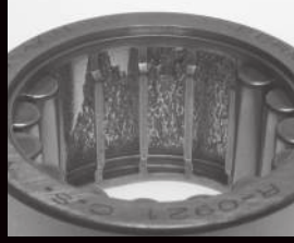
Dış bilezik yuvarlanma yüzeyinde Bölgesel Yüzey Karıncalanması (BYK)
