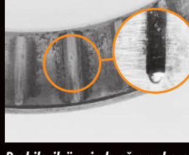
Dış bilezik üzerinde ağır makara aşındırma izleri
