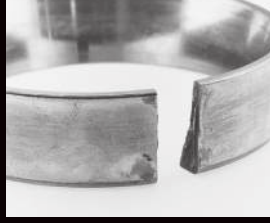
Deforme olmuş veya kırılmış kap ile sonuçlanabilecek gevşek montaj
