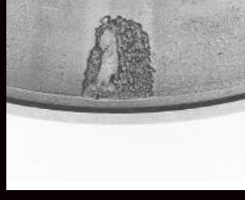
Dış bilezik yuvarlanma yüzeyinde parça atmasına neden olur
