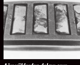
Ağır yüklerden dolayı aşırı yorulmuş makara
