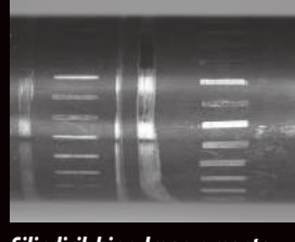
Silindirik bir rulmanın monte edildiği bir mil üzerinde yalancı brinell darbe hasarı
