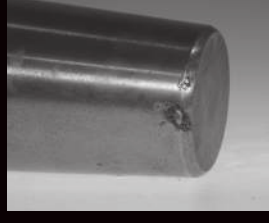
Elektrik arka yanıkları bulunan makara
