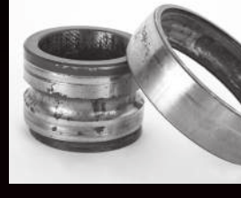
Gelişmiş paslanma ve aşınma
