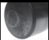
Estremità del rullo con usura da adesione
