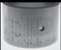
Attacco chimico e corrosione
