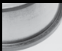
Sovratemperatura sviluppata in corrispondenza del bordino dell'anello interno/testa grande dei rulli
