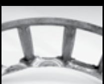
I rulli, vibrando a causa del troppo gioco interno, urtano in modo energetico la gabbia deformandola plasticamente
