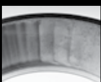
Dentellature sulla coppa causati da un gioco di registrazione eccessivo
