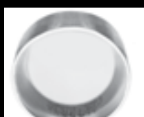
Percorso ellittico del rullo causato dal disallineamento
