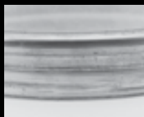
Accoppiamento troppo lasco dell'anello esterno su un mozzo ruota
