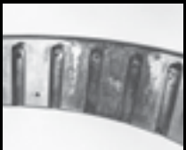
Falso brinelling profondo sulla pista di un anello esterno
