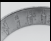
Scheggiature equidistanziate pari al passo dei rulli
