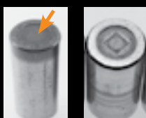
Sovratemperatura sviluppata in corrispondenza della testa sferica dei rulli/bordino dell'anello interno
