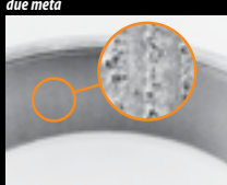
Microfusioni da arco elettrico
