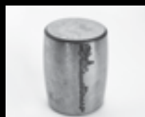
Corrosione in stato avanzato
