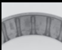
Leggera corrosione sulla pista esterna
