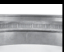
Bruciature da corrente elettrica
