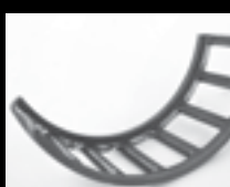
Deformazione plastica delle tasche della gabbia, compresi i ponticelli, dovuta ad eccessive vibrazioni dei rulli in fase operativa
