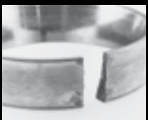
L'accoppiamento eccessivamente libero ha causato lo stiramento e la rottura di un anello esterno
