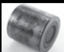
Appiattimenti del rullo, usura da adesione e da slittamento del rullo sulla superficie della pista
