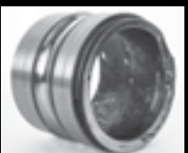
L'accoppiamento con un albero sotto dimensionato ha portato ad una rottura verso l'estremità di un anello interno
