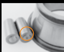
Contaminazione da particelle fini
