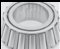
Frattura dell'anello interno dovuta ad un accoppiamento troppo forzato
