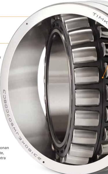
**Eficiencia optimizada:** eliminar el anillo de la guía central reduce el torque hasta en un 4%. Sin el anillo guía hay menos fricción, lo que significa que se requiere de menor energía para mover el rodamiento y mantenerlo en operación. Esto resulta en una eficiencia mejorada.
