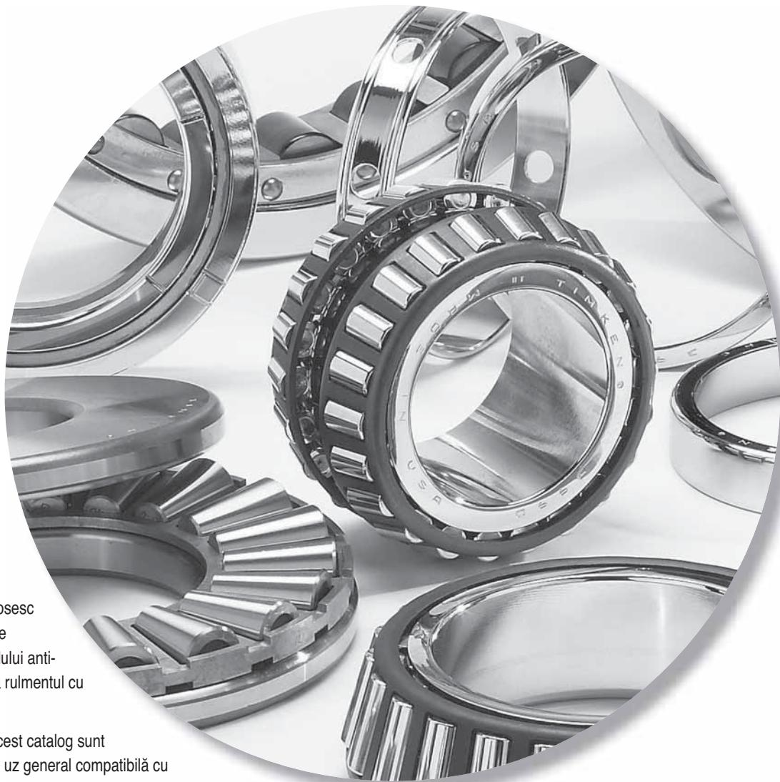
Majoritatea tipurilor de rulmenți sunt expediați, în mod ușual, protejați cu un fluid având proprietăți anti-corozione, care nu este un lubrifiant. Asemenea rulmenți se pot folosi în aplicații lubrificate cu ulei fără îndepărarea fluidului anti-corozione. Atunci când se folosesc la lubrificare unsori speciale, se recomandă îndepărarea fluidului anti-corozione înainte de a lubrifica rulmentul cu unsoarea respectivă.
