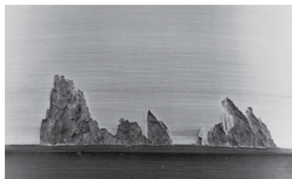
Fig. 2: Descascamento por concentração de tensão geométrica (GSC)
