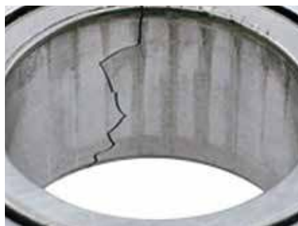
Danos no furo do cone do rolamento (pista interna) - Fratura na pista interna causada por um eixo ovalizado ou grande demais.
