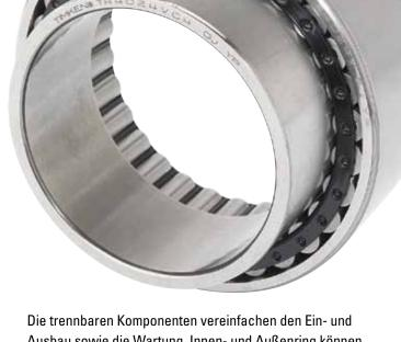
Die trennbaren Komponenten vereinfachen den Ein- und Ausbau sowie die Wartung. Innen- und Außenring können in beiden Ausrichtungen montiert werden. Dadurch werden Montagefehler vermieden. Spezialwerkzeuge sind nicht erforderlich.
