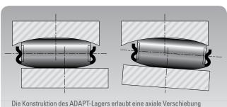
Die Konstruktion des ADAPT-Lagers erlaubt eine axiale Verschiebung sowie eine Fehlausrichtung von maximal 0,5 Grad. Die Rollkörper fluchten unabhängig von Axialverschiebung und Fehlausrichtung mit dem Innenring.
