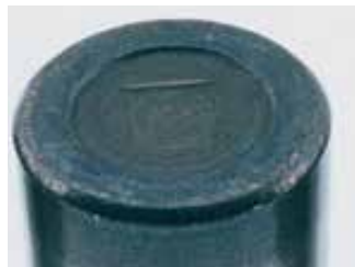
轴承内圈大挡边面划痕: 金属与金属直接接触导致的粘结和热损伤。
