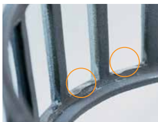
保持架窗孔磨损: 轴承转动太松导致的滚子和保持架窗孔表面较重的撞击。
