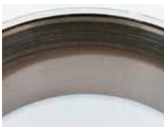
由于偏斜、不准确的加工或轴承座磨损造成 不规则的滚子路径 。
