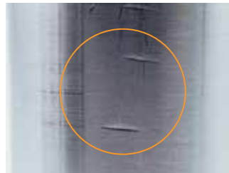
滚子刻痕与凹痕: 野蛮装卸或安装损伤。
