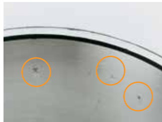
滚子间距的刻痕: 与滚子边缘撞击而导致套圈上凸起的金属。
