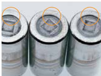
滚子端面划痕: 润滑油膜破裂造成的金属接触。
