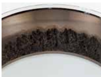
由于偏斜、不准确的加工或轴承座磨损造成 不规则的滚子路径 。
