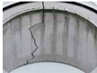
轴承内圈孔损伤: 由于轴圆度或尺寸超差引起内圈破裂。
