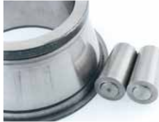
磨粒磨损： 细小磨料颗粒污染。
