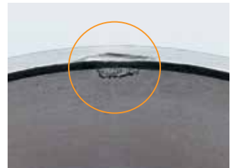
轴承外圈——端面凹痕: 硬钢棒压痕。
