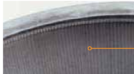
电弧条形纹： 旋转时电流通过轴承造成的轴向烧伤。
