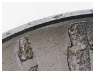
线条状剥落： 蚀刻损伤后因轴承转动产生滚子占用部位的剥落。
