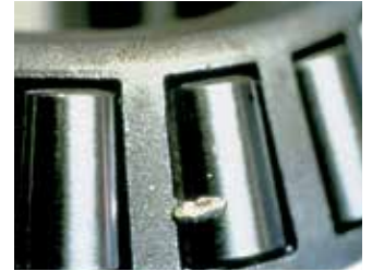
沟槽： 镶嵌到软质保持架材料里的大颗粒污染物。
