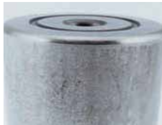
微剥落： 由于高载荷和低转速或温度升高造成润滑油膜过薄。
