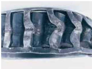
轴承锁死: 滚子倾斜并倒向一边。
