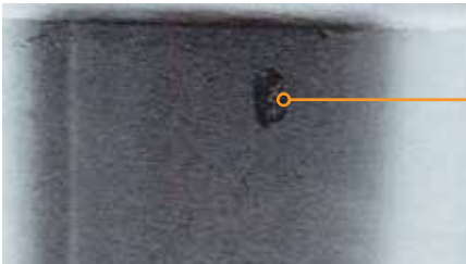
电弧蚀斑： 轴承静止时电气接地不当造成的灼伤。
