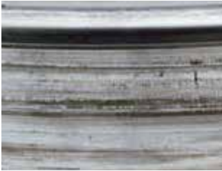
轴承外圈跑圈： 转动的轮毂上外圈配合较松。
