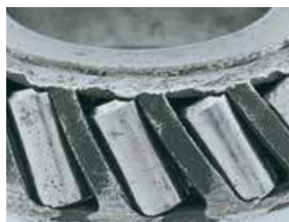
滚子卡死和歪斜: 安装或维修期间保持架被压变形或运行时有干涉。
