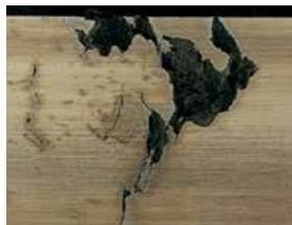
点源剥落 (PSO): 碎片和凸起的金属超过润滑油膜厚度。
