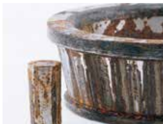
蚀刻： 蚀损斑和潮湿引起的生锈。
