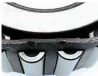
保持架变形: 轴承安装不当或掉落。
