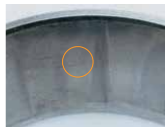
扇状磨损: 轴向游隙偏大导致的局部磨损不均。
