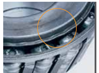
轴承内圈大挡边面变形: 过多的热量产生的金属流动。
