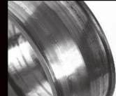
Desgaste adhesivo en el anillo interior del rodamiento
