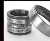
Corrosión y oxidación avanzadas
