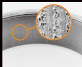
Erosión por arco eléctrico durante operación
