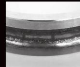
Descascarillado y fatiga por precarga excesiva
