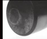
Extremo del rodillo con desgaste adhesivo
