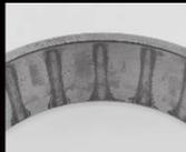
Manchas de agua en la pista de rodadura externa
