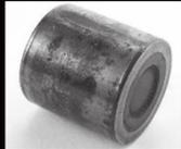
Rodillo con una mancha plana; desgaste adhesivo y por deslizamiento en la superficie de la pista de rodadura
