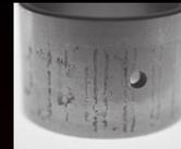
Oxidación y corrosión
