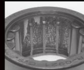
Descascarillado en orilla por concentración de tensión geométrica en el anillo exterior
