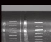
Falso efecto Brinell en un eje cuando se montó un rodamiento cilíndrico
