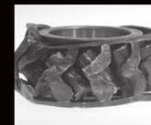
Deformación del reborde de la pista interior de rodadura por generación excesiva de calor
