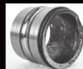
Fractura en el anillo interior extendido con collarín excéntrico debido a un eje demasiado pequeño
