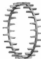
Rys. 5. Kosz jednoczęściowy typu palcowego z mosiądku obrabionego maszynowo, prowadzony na elementach tocznych.
