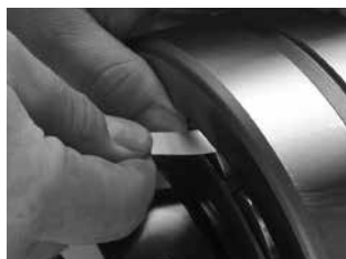
Fig. 14. Misurare il GRI prima dell'installazione.
