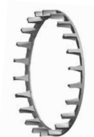
Fig. 7. Gabbia in ottone fresata, di tipo a pettine, costituita da due pezzi, guidata sull'anello interno.
