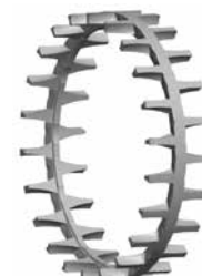
Fig. 6. Gabbia lavorata in ottone, di tipo a pettine, costituita da un unico pezzo, guidata sull'anello interno.
