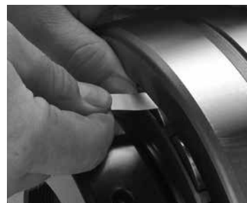
Fig. 18. Misurazione del GRI prima dell'installazione.
