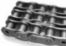
符合或高于ANSI标准，适用于条件恶劣、对性能要求高的应用领域。                      | <ul style="list-style-type: none"><li>» 宽腰链板有助于改善应力分布，提高性能</li><li>» 长节距滚子链板在热处理球化后，以增加疲劳强度</li><li>» 链条安装后预载荷达到50%</li><li>» 可提供工程级别的链条</li></ul>            |
