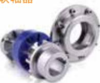
易于安装，无需润滑，使用寿命与旋转设备寿命匹配，有助于保持相对较低的总体运行成本。           | <ul style="list-style-type: none"><li>» 扭矩传输能力相当于或超过相似尺寸的齿轮、蛇簧、链条或其它弹性联轴器</li><li>» 插芯更换简单，无需移动轮毂——几分钟即可完成维护</li><li>» 尺寸基本上可满足所有需要，多种轮毂与轴组合方式，便于安装</li></ul> |
