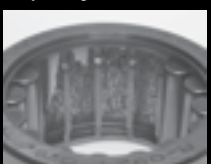
Ermüdungsbüche durch lokale Überlastung auf der Laufbahn eines Außenrings
