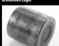
Flachstellen auf den Wälzkörpern, adhäsiver Verschleiß und Anschmierungen durch Gleiten auf der Laufbahn
