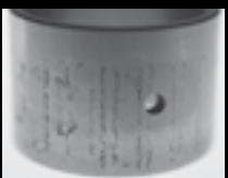
Korrosions- und Ätznarben
