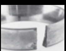
Lose Passung, die zum Ausweiten und Brechen des Außenrings führt
