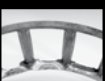
Käfigtaschenverschleiß durch nicht ausreichend geführte Wälzkörper
