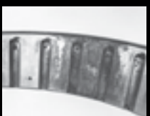
Extreme Riffelbildung auf einer Außenringlaufbahn
