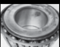
Laufbahnverformung durch übermäßige Wärmeentwicklung
