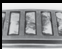
Stark ermüdete Wälzkörper aufgrund schwerer Lasten
