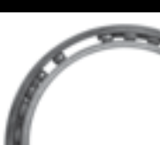
Käfigschäden durch Blockade des Lagers
