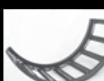
Verschleiß an den kleinen Innenseiten der Käfigtaschen und den Käfigbrücken
