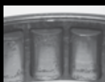
Ermüdungserscheinungen aufgrund schwerer Lasten
