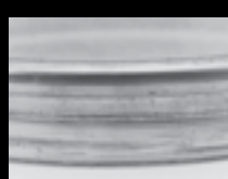
Riefenbildung durch lose Passung zwischen Außenring und Gehäuse
