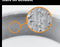
Riffelbildung verursacht durch Lichtbögen beim drehenden Lager
