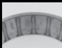
Feuchtigkeitskorrosion bei längerem Stillstand
