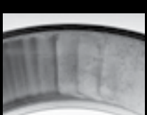
Schlupfspuren am Außenring durch übermäßiges Axialspiel
