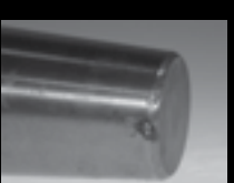
Wälzkörper mit Verbrennungen durch Lichtbogen
