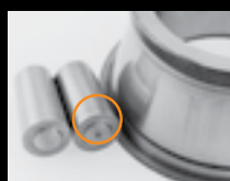
Kontaminierung durch abrasive Feinstpartikel
