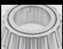
Innenringbruch durch zu starke Passung
