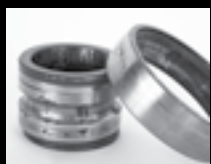
Starke Korrosion mit Ätznarben
