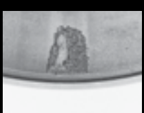
Örtlich begrenzte Ausbrüche durch Spannungsanstieg auf der Außenringlaufbahn
