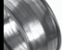
Rulman iç bileziğinde sivama aşınması
