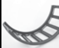
Makara köprüleri üzerinde ve kafes cebinin küçük uçlarında aşınma
