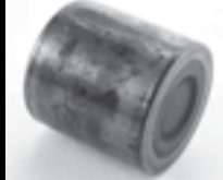
Makaranın düzleşmesi, makaraların yuvarlanma yüzeyi üzerinde kayarak ilerlemesi kaynaklı aşınma
