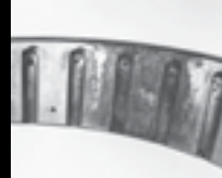
Dış bilezik üzerinde ağır makara aşındırma izleri
