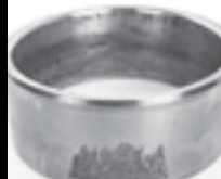
İç bilezik yuvarlanma yüzeyinde Bölgesel Yüzey Karıncalanması (BYK)
