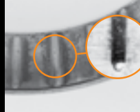
Dış bilezik üzerinde ağır makara aşındırma izleri
