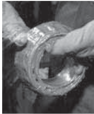
Abb. 149. Schmierfett kann einfach von Hand aufgetragen werden.
