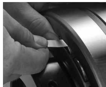
Fig. 18. Mesure du jeu radial interne avant l'installation.
