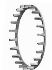
Fig. 7. Cage à ergots en deux parties, usinée en laiton, guidée par la bague intérieure.
