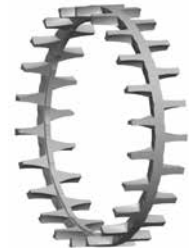
Fig. 6. Cage monobloc à cames ou ergots, usinée en laiton, guidée par la bague intérieure.
