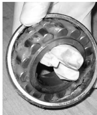
Fig. 21. La graisse peut être appliquée facilement à la main.
