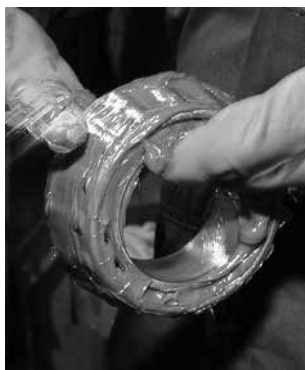
Fig. 15. Il riempimento con grasso può essere facilmente effettuato a mano.
