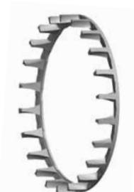
Fig. 7. Colivie din două bucăți, din alamă prelucrată mecanic prin așchiere, cu locașuri deschise la un capăt, cu ghidare pe inelul interior.
