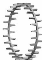
Fig. 5. Colivie monobloc din alamă prelucrată mecanic prin așchiere, cu locașuri deschise la un capăt, cu ghidare pe role.
