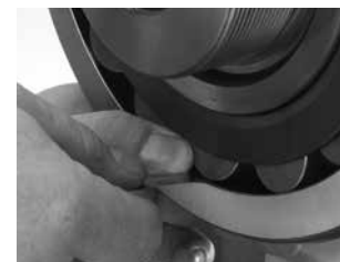
Fig. 15. În timpul montării, jocul radial intern trebuie măsurat la o rolă aflată în afara zonei de încărcare.
