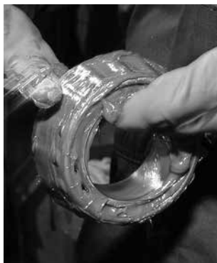
Img. 15. Unsoarea se poate aplica ușor manual.
