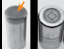
Grippage de l'extrémité du rouleau - "Soudage" et détérioration par chaleur excessive due au contact métal sur métal.
