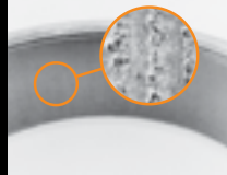
Série de petites brûlures axiales causées par le courant électrique en circulation
