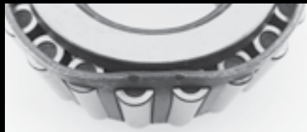
Déformation de la cage
