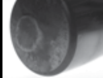
Extrémité du rouleau avec usure adhésive
