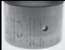
Attaque et corrosion
