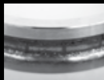
Ecaillage de fatigue dû à une précharge excessive
