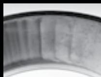
"Scalloping" - Usure irrégulière localisée due à un jeu de fonctionnement excessif
