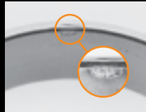
Enfoncement sur la face de la bague extérieure
