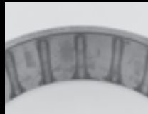
Légère corrosion sur la bague extérieure
