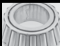
Fracture de la bague intérieure
