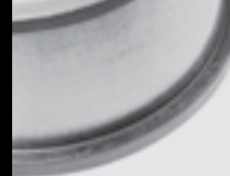
Grippage de la face de la grande calerette du cône - "Soudage" et détérioration par chaleur excessive due au contact métal sur métal.
