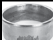
Ecaillage dû à la concentration de contraintes géométriques (GSC) sur la bague intérieure
