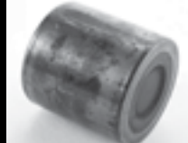
Quelques méplats sur la surface du galet, traces de glissement et présence d'usure adhésives
