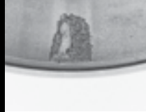
Ecaillage localisé sur le chemin de la bague intérieure résultant d'une concentration de contraintes créée par le pincement
