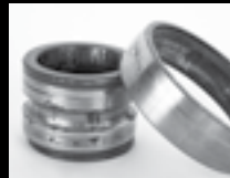
Corrosion et attaque avancées
