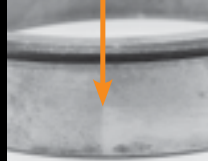
Marque de pincement causée par un logement en deux parties
