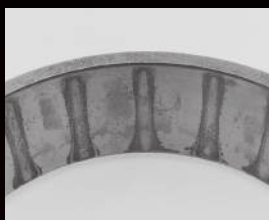
Plamy powierzchniowe na bieżni pierścienia zewnętrznego
