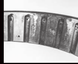
Rozległe fałszywe odciski Brinella na bieżni pierścienia zewnętrznego
