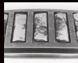
Rozległe wrywy będące następstwem przekroczenia naprężeń
