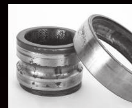
Silna korozja i wżery
