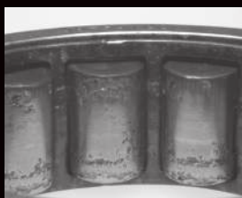
Uszkodzenie zmęczeniowe spowodowane dużymi obciążeniami
