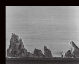
Koncentracja naprężeń na krawędzi bieżni (GSC) - wrywy
