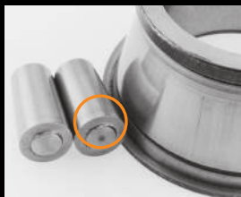
Zanieczyszczenie drobnymi cząstkami ściernymi
