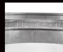
Ślady przypalenia na powierzchni bieżni
