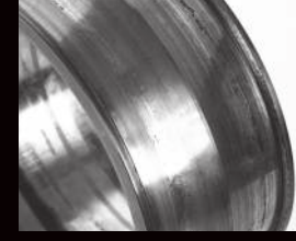
Zużycie bieżni pierścienia wewnętrznego łożyska
