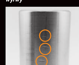
Zakaleczenia i wgniecenia spowodowane nieprawidłowym obchodzeniem się z łożyskiem
