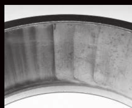
Ślady ząbkowania na bieżni pierścienia zewnętrznego spowodowane nadmiernym luzem wewnętrznym łożyska
