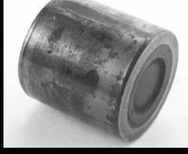
Spłaszczenia powierzchni wałeczka spowodowane ślizganiem się po powierzchni bieżni
