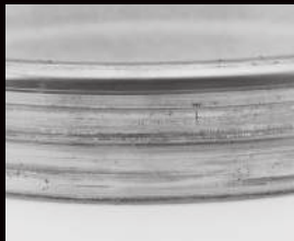
Luźne pasowanie pierścienia zewnętrznego w płaszcz koła
