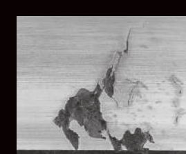
Punktowe odpryski na powierzchni (PSO)
