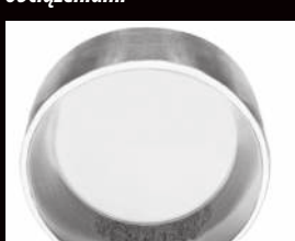
Nieregularny ślad toczenia wałeczków spowodowany niwspółosiowością
