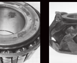
Deformacja bieżni na skutek wysokiej temperatury pracy
