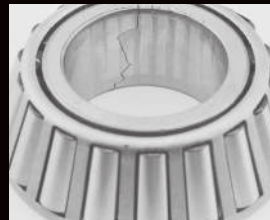
Pęknięcie pierścienia wewnętrznego
