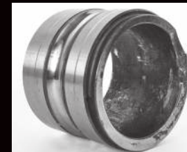
Pęknięty poszerzony pierścień wewnętrzny w wyniku osadzenia pierścienia na wale o obniżonej średnicy
