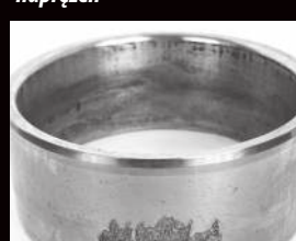
Koncentracja naprężeń na krawędzi bieżni (GSC) - wrywy na pierścieniu wewnętrznym
