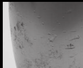
Zanieczyszczenie twardymi cząstkami ściernymi
