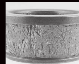
Znaczne złuszczenie i odpryski wywołane dużymi obciążeniami
