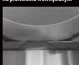
Pęknięcie obrzeża pierścienia wewnętrznego
