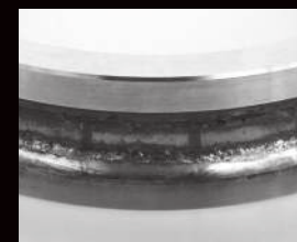
Odpryski zmęczeniowe spowodowane nadmiernym napięciem wstępnym
