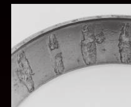
Uszkodzenie liniowe w odstępach odpowiadających rozstawowi wałeczków
