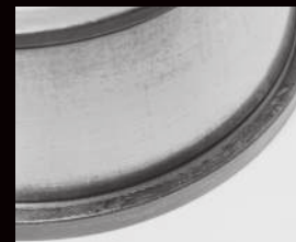
Przypalenie powierzchni bieżni pomocniczej
