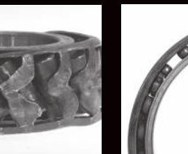
Uszkodzenie kosza na skutek ukosowania wałeczków i blokady łożyska
