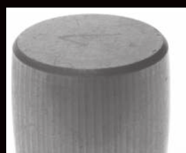
Rowkowanie spowodowane łukiem elektrycznym
