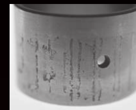
Korozja i wżery
