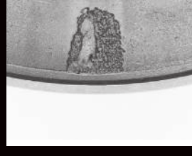
Miejscowa wrywa powstała na powierzchni bieżni spowodowana nierównością gniazda oprawy dzielonej
