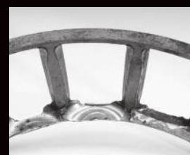
Zużycie okienek kosza z powodu niewłaściwego toczenia się (wężykowania) wałeczków
