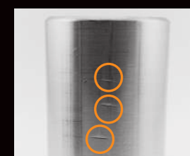
Știrbiri și imprimări cauzate de manipulare neglijentă
