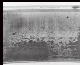
Exfoliere cu granulație fină
