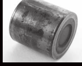
Suprafețe plane de uzură pe role, uzură de aderență și de patinare pe suprafața căii de rulare
