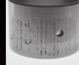
Oxidare și coroziune
