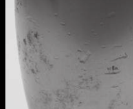
Contaminare cu particule dure- amprentare
