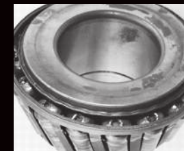
Deteriorare prin microsudura a capului sferic al rolei
