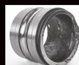
Inel interior lat cu manșon de blocare, spart din cauza arborelui subdimensionat
