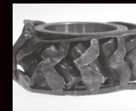
Deformarea căii de rulare în urma producerii excesive de căldură
