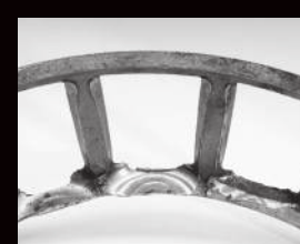
Uzura locașului coliviei din cauza mișcării excesive a rolei
