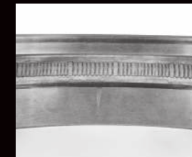
Role cu arsuri datorate arcului electric
