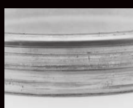
Inel exterior montat cu ajustaj cu joc mare într-un butuc de roată de autovehicul
