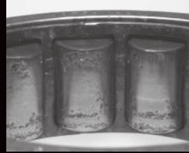
Exfoliere cauzată de oboseală datorată încărcărilor mari
