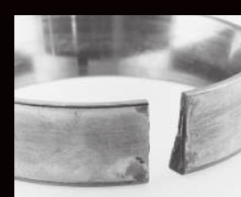
Montare cu ajustaj cu joc rezultând un inel exterior supus la întindere și fracturat
