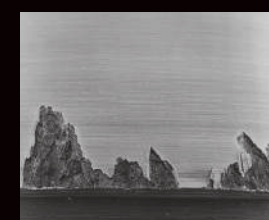
Exfoliere din cauza concentrării de tensiuni (GSC)
