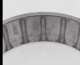
Coroziune ușoară pe căile de rulare exterioare
