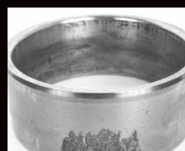
Exfoliere din cauza concentrării de tensiuni (GSC) pe inelul interior
