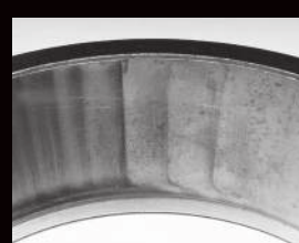
Urme de surfilare pe calea de rulare a inelului exterior cauzate de jocul axial excesiv
