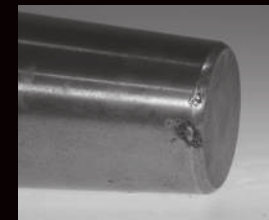
Role cu arsuri datorate arcului electric
