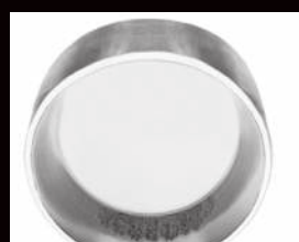
Amprenta de formă eliptică a rolei pe calea de rulare a inelului, cauzată de dezalinare
