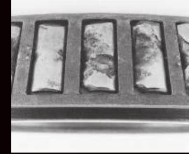
Role cu exfoliere masivă cauzată de oboseală datorată încărcărilor mari
