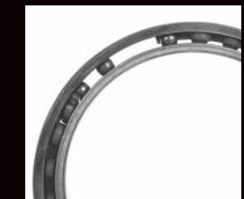
Deteriorarea coliviei în urma blocării complete a rulmentului
