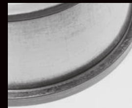
Deteriorare prin supraîncălzire a umărului mare al inelului interior
