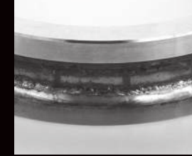
Exfoliere cauzată de oboseală în urma pretensionării excesive
