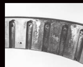
Amprentare falsă masivă pe calea de rulare a inelului exterior
