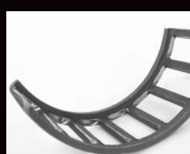
Uzură la capetele mici ale locașurilor coliviei și pe punțile dintre role
