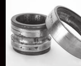
Coroziune și oxidare avansată
