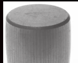
Canelare cauzată de curentul electric
