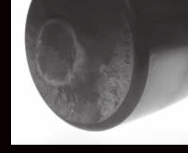
Cap de rolă cu uzură de aderență
