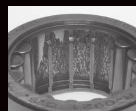
Exfoliere din cauza concentrării de tensiuni (GSC) pe inelul exterior
