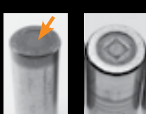
Deteriorare prin supraîncălzire a capului sferic al rolei
