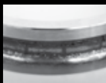
Exfoliere cauzată de oboseală în urma pretensionării excesive
