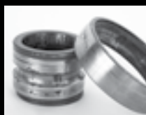
Coroziune și oxidare avansată
