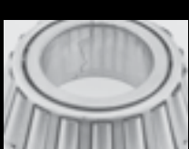
Fractură pe inelul interior
