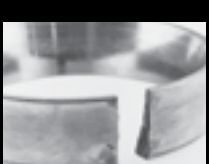
Montare cu ajustaj cu joc rezultând un inel exterior supus la întindere și fracturat
