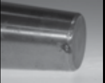
Role cu arsuri datorate arcului electric
