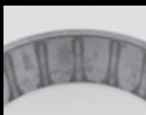
Coroziune ușoară pe căile de rulare exterioare
