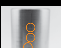
Știrbiri și imprimări cauzate de manipulare neglijentă
