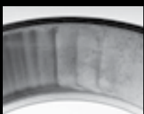
Urme de surfilare pe calea de rulare a inelului exterior cauzate de jocul axial excesiv
