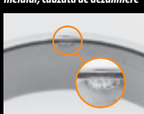
Imprimare pe fața inelului exterior
