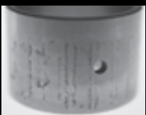
Oxidare și coroziune
