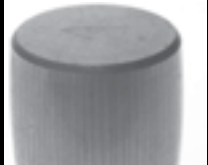
Canelare cauzată de curentul electric
