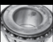
Deteriorare prin microsudură a capului sferic al rolei
