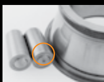
Contaminare cu particule fine
