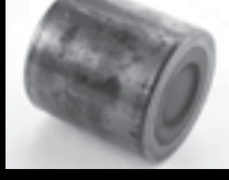
Suprafețe plane de uzură pe role, uzură de aderență și de patinare pe suprafața căii de rulare
