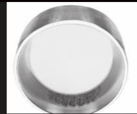
Percorso ellittico del rullo causato dal disallineamento
