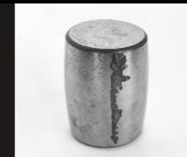
Corrosione in stato avanzato
