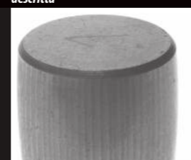
Microfusioni causate da archi voltaici a seguito del passaggio di corrente elettrica attraverso un cuscinetto in rotazione
