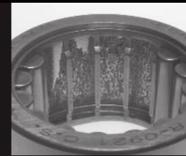
Frattura da concentrazione di stress geometrico (GSC) verso un'estremità dell'anello esterno
