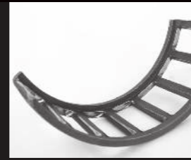
Deformazione plastica delle tasche della gabbia, compresi i ponticelli, dovuta ad eccessive vibrazioni dei rulli in fase operativa
