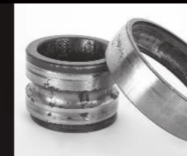
Corrosione ed attacco chimico in stato avanzato
