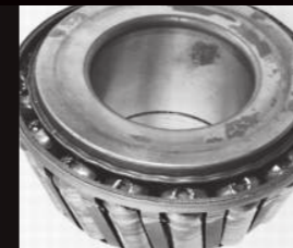
Grippatura della testa grande dei rulli
