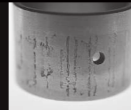
Attacco chimico e corrosione
