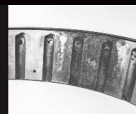
Falso brinelling profondo sulla pista di un anello esterno
