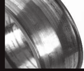
Usura da adesione con i rulli dell'anello interno di un cuscinetto
