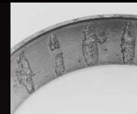
Scheggiature equidistanziate pari al passo dei rulli
