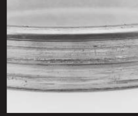
Accoppiamento troppo lasco dell'anello esterno su un mozzo ruota
