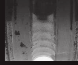
Elevati e ripetuti urti hanno causato la deformazione permanente della pista di un cuscinetto a sfere
