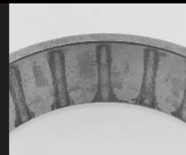
Logora corrosione sulla pista esterna
