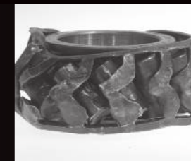
Deformazione plastica del bordino del corno a causa di eccessiva generazione di calore
