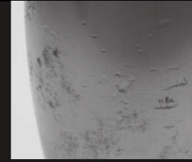
Contaminazione da particelle dure
