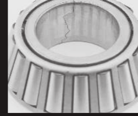
Frattura dell'anello interno dovuta ad un accoppiamento troppo forzato
