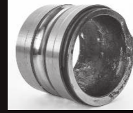
L'accoppiamento con un albero sotto dimensionato ha portato ad una rottura verso l'estremità di un anello interno
