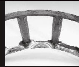
I rulli, vibrando a causa del troppo gioco interno, urtano in modo energico la gabbia deformandola plasticamente
