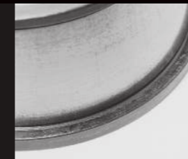
Sovratemperatura sviluppata in corrispondenza del bordino dell'anello interno/testa grande dei rulli
