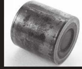
Appiattimenti del rullo, usura da adesione e da slittamento del rullo sulla superficie della pista
