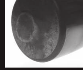
Estremità del rullo con usura da adesione
