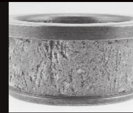
Profonda frattura estesa a tutta la pista di rotolamento dovuta a sovraccarico in fase operativa
