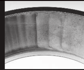
Dentellature sulla coppa causati da un gioco di registrazione eccessivo
