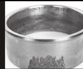
Frattura da concentrazione di stress geometrico (GSC) verso un'estremità dell'anello interno
