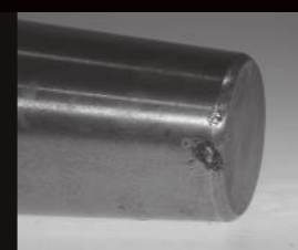
Rullo con bruciature da arco elettrico
