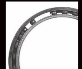
Danneggiamento della gabbia dovuto all'intravedimento dei rulli e conseguente bloccaggio del cuscinetto
