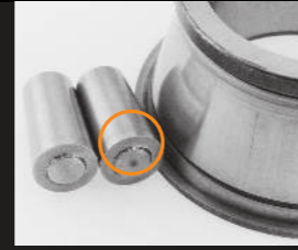
Contaminazione da particelle fini
