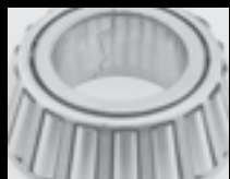
Frattura dell'anello interno dovuta ad un accoppiamento troppo forzato
