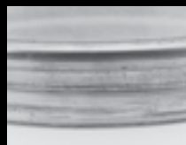
Accoppiamento troppo lasco dell'anello esterno su un mozzo ruota
