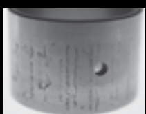
Attacco chimico e corrosione
