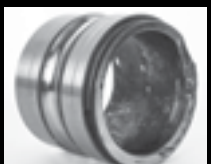
L'accoppiamento con un albero sotto dimensionato ha portato ad una rottura verso l'estremità di un anello interno
