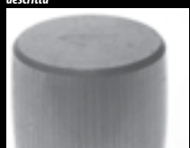
Microfusioni causate da archi voltai a seguito del passaggio di corrente elettrica attraverso un cuscinetto in rotazione
