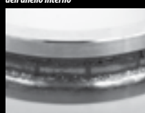
Frattura a fatica dovuta ad eccessivo precarico dimensionale
