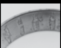
Scheggiature equidistanziate pari al passo dei rulli
