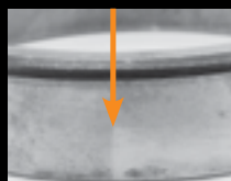
Impronta lasciata sul diametro esterno, a causa di un errore di coassialità di un alloggiamento in due metà
