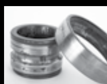
Corrosione ed attacco chimico in stato avanzato
