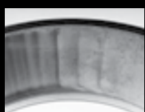
Deformazione plastica delle tasche della gabbia, compresi i ponticelli, dovuta ad eccessive vibrazioni dei rulli in fase operativa
