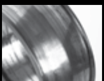
Appiattimenti del rullo, usura da adesione e da slittamento del rullo sulla superficie della pista
