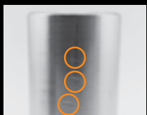
Ammaccature causate da una movimentazione non attenta
