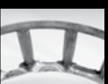
Desgaste en anillos de la ventana de la jaula provocado por un movimiento excesivo de los rodillos
