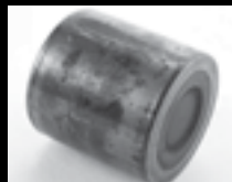
Rodillo con una mancha plana; desgaste adhesivo y por deslizamiento en la superficie de la pista de rodadura
