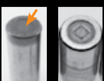
Escoriación ocasionada por el calor en el reborde y el extremo del rodillo
