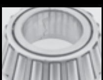
Fractura en el anillo interior
