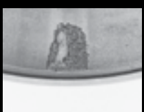
Descascarillado resultante del punto elevado en el alojamiento
