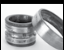
Corrosión y oxidación avanzadas
