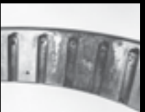
Falso efecto Brinell grave en la pista de rodadura externa
