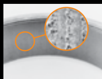
Erosión por arco eléctrico durante operación
