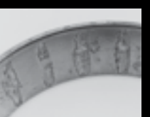
Descascarillado en el lugar de los rodillos
