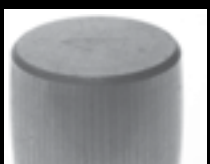
Erosión en rodillos por la corriente eléctrica durante operación
