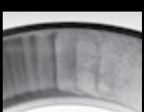
Marcas de ondulado en la pista de la taza provocadas por una holgura axial excesiva
