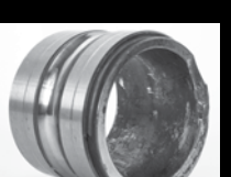
由于轴尺寸不足造成带锁紧套的宽内圈断裂
