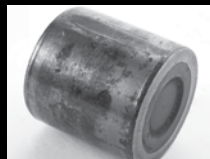
滚动体磨出平面，滚道上出现粘合磨损
