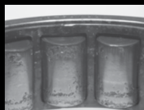
过载导致的疲劳剥落
