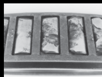
过载导致滚子严重疲劳剥落
