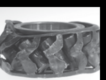
过热导致的挡边变形
