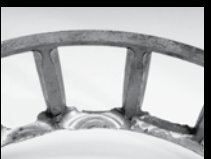
滚子过度移动导致保持架兜孔磨损
