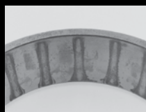
外圈轻微腐蚀
