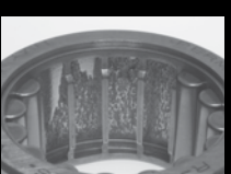
外圈上的几何应力集中 (GSC) 剥落
