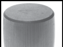
电流造成的凹槽
