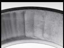
轴端游隙过大导致外圈扇形纹
