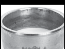
内圈上的几何应力集中 (GSC) 剥落
