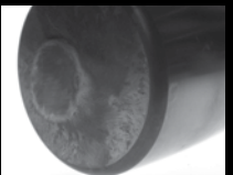
粘合磨损的滚子端面
