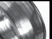
轴承内圈粘合磨损
