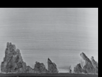
几何应力集中 (GSC) 剥落
