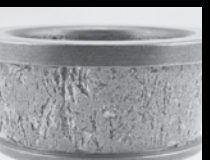
过载导致严重脱皮和剥落
