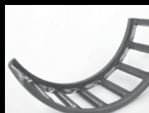
保持架兜孔小端和保持架梁磨损
