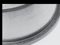
挡边和滚子端面的热损伤
