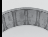
外輪の軽度な腐食
