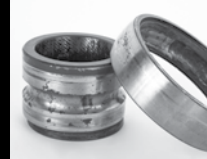
高度な腐食とエッチング
