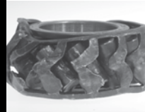
過熱によるレースの変形
