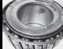
ローラー端部の金属接触による損傷
