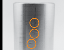
乱雑な取扱いにより生じた傷とへこみ
