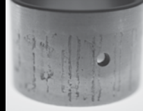
エッチングと腐食
