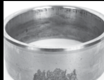
幾何学的応力集中 (GSC) による内輪の破損
