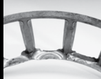
ローラーの過度な動きによるケージポケットの摩耗
