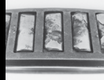
重荷重によるひどいローラー疲労
