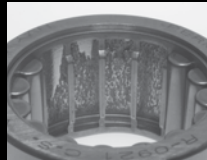
幾何学的応力集中 (GSC) による外輪の破損
