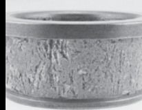
重い負荷によるひどい剥離と破損
