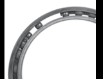
ベアリングロックアップによるケージの損傷
