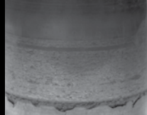
粘着性摩耗を伴う球面ローラーベアリング
