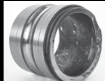
シャフトが小さすぎるため、ロックカラー付きの幅の広い内輪が破損している
