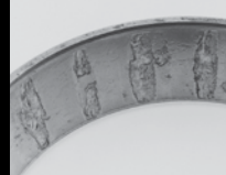
ローラー間隔で発生する損傷
