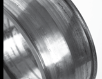
ベアリング内輪の粘着性摩耗
