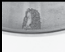
Характерное локальное выкрашивание на дорожке качения
