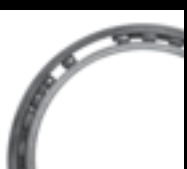
Повреждение сепаратора вследствие заклинивания подшипника
