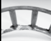
Износ окна сепаратора из-за неравномерного движения роликов
