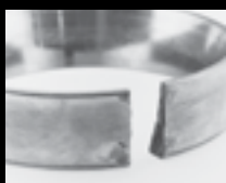
Растяжение и разрыв кольца в результате свободной посадки
