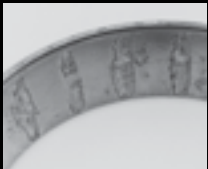
Выкрашивание участками с шагом, равным расстоянию между роликами
