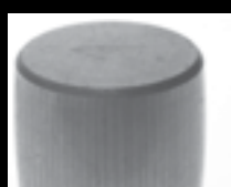
Рифление вследствие ожогов, вызванных электрическим током
