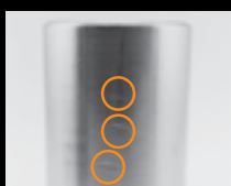
Вмятины и заусеницы вследствие неосторожного обращения
