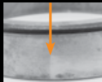
Видимая отметка от выступа внутри корпуса
