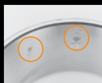
Вмятины с шагом, равным расстоянию между роликами
