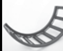
Износ ушек сторон колец и перемычек сепаратора
