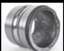
Трещины в широкой внутренней обойме со стопорным кольцом из-за недостаточного размера вала
