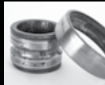
Сильная коррозия и травление
