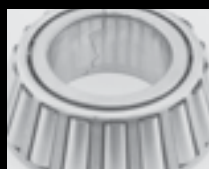
Трещина во внутреннем кольце
