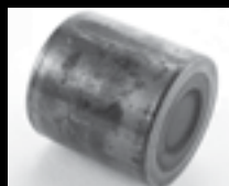
Флоксы на роликах, адгезивный износ и износ от скольжения на поверхности дорожки качения
