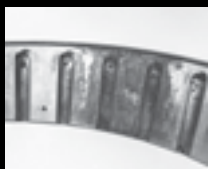
Сильное ложное бринеллирование на наружной дорожке качения
