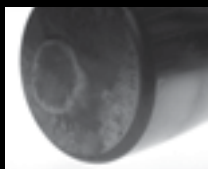
Адгезивный износ торца ролика
