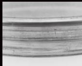
Ajustement libre de la bague extérieure dans un moyeu de roue.
