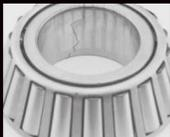
Fracture de la bague intérieure
