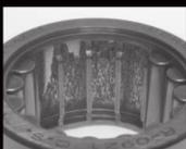
Ecaillage dû à la concentration de contraintes géométriques (GSC) sur la bague extérieure
