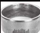
Ecaillage dû à la concentration de contraintes géométriques (GSC) sur la bague intérieure
