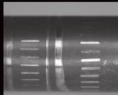
Fausse marques de Brinell sur un arbre sur lequel un roulement à rouleaux cylindriques était installé.
