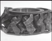
Déformation de la face de la grande collerette du cône - Fluage du métal causé par une génération de chaleur excessive
