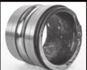
Rupture de la bague intérieure munie d'un collier excentrique de serrage causée par un diamètre d'arbre trop faible.
