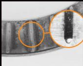
Usure causée par des vibrations
