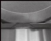
Rupture de la collerette sur la bague intérieure
