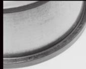
Grippage de la face de la grande collerette du cône - "Soudage" et détérioration par chaleur excessive due au contact métal sur métal.
