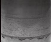
Roulement à rouleaux sphériques avec usure adhésive
