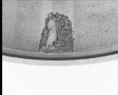
Ecaillage localisé sur le chemin de la bague extérieure résultant d'une concentration de contraintes créée par le pincement
