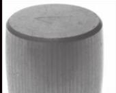
Série de petites brûlures axiales sur le rouleau causées par le courant électrique en circulation
