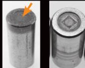
Grippage de l'extrémité du rouleau - "Soudage" et détérioration par chaleur excessive due au contact métal sur métal.
