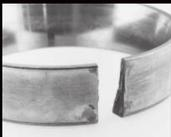
Ajustement libre entraînant un étirement et une rupture de la cuvette
