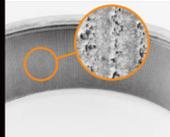
Série de petites brûlures axiales causées par le courant électrique en circulation
