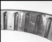
Usure causée par un mouvement axial relatif entre les rouleaux et le chemin.
