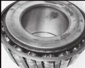
Début de grippage de l'extrémité du rouleau - contact métal - métal dû à la rupture du film de lubrifiant.
