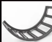
Usure des alvéoles de cage - Contact élevé entre les rouleaux et les surfaces des alvéoles de cage
