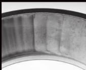
"Scalloping" - Usure irrégulière localisée due à un jeu de fonctionnement excessif
