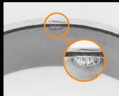
Enfoncement sur la face de la bague extérieure
