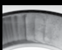
Marcas de ondulado en la pista de la taza provocadas por una holgura axial excesiva
