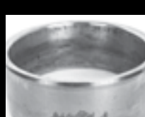
Descascarillado por concentración de tensión geométrica en el anillo interior
