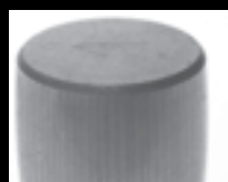
Erosión en rodillos por la corriente eléctrica durante operación
