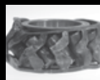
Deformación del reborde de la pista interior de rodadura por generación excesiva de calor
