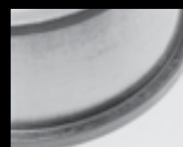
Escoriación ocasionada por el calor en el reborde y el extremo del rodillo
