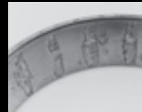
Descascarillado en el lugar de los rodillos
