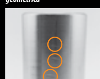
Imperfecciones y abolladuras por maltrato
