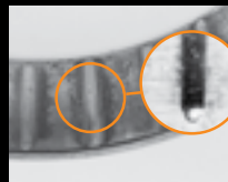
Falso efecto Brinell grave en la pista de rodadura externa
