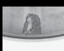
Descascarillado resultante del punto elevado en el alojamiento
