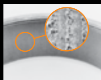
Erosión por arco eléctrico durante operación
