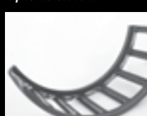
Desgaste en los extremos pequeños de la ventana y puentes de la jaula
