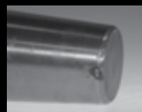
Rodillo con quemaduras por arco eléctrico
