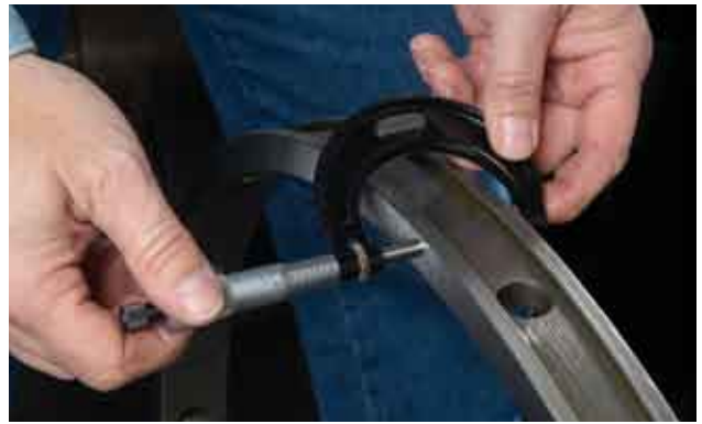
图20 测量B、D和C隔圈宽度
