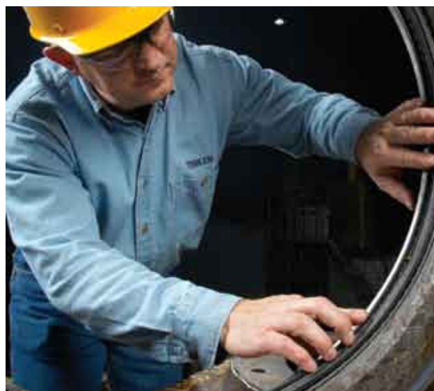
图29 检查密封圈，如有必要应予以更换
