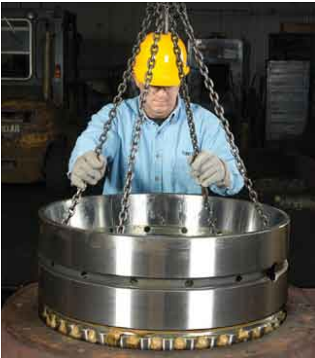
图 36 将底部双内圈和双外圈装入轴承座
