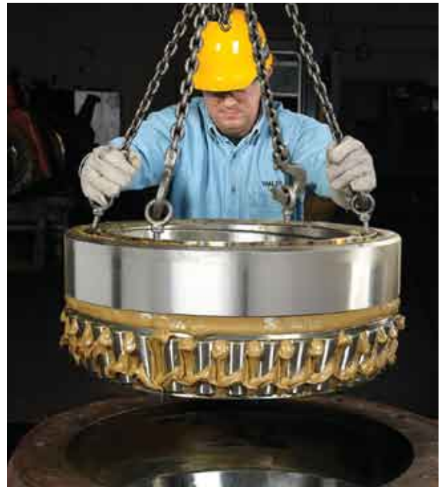
图38 最后，将顶部双内圈和单外圈安装到轴承座内
