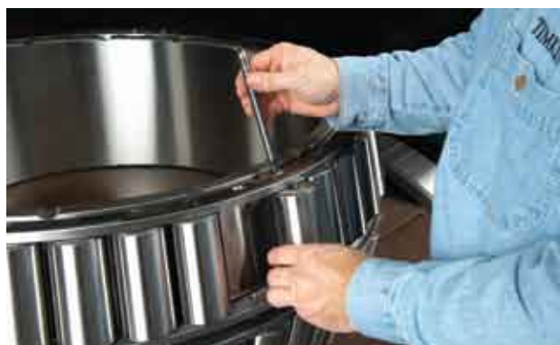
图12 取出滚子，检查内圈外径或滚道
