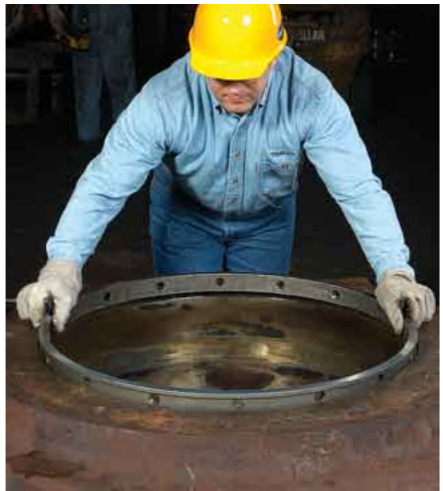
图34 安装外圈隔圈
