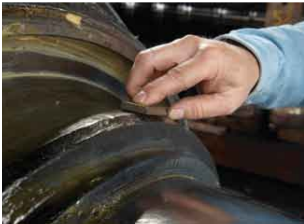
图44 磨去轧辊颈与密封唇边接触表面的所有毛刺和尖锐边缘
