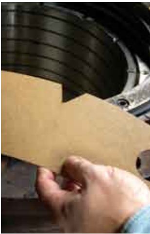
图39 在垫片上剪出V形切口
