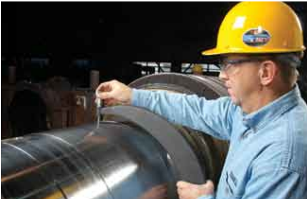
图41 安装轴承前，检查轧辊颈尺寸
