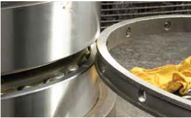
图21 具有适当内部轴向游隙的轴承，其隔圈宽度大于隔圈间隙
