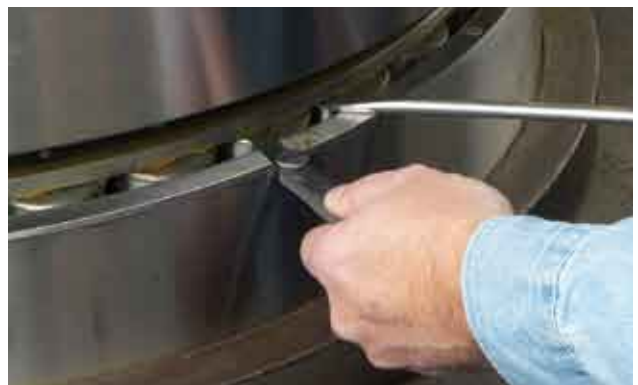
图18 使用塞规检测轴承部件的贴合情况
