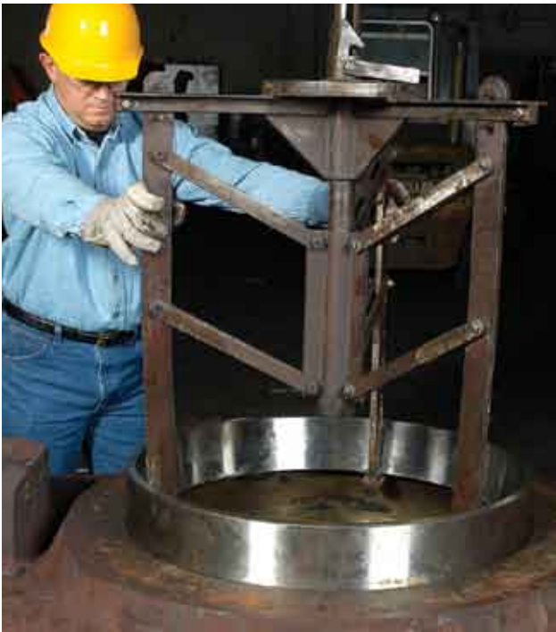
图33 将底部外圈装入轴承座
