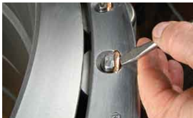
图11 移去柱销上的安全锁紧丝
