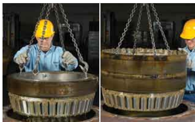
图8 取出顶部单外圈和顶部双内圈
