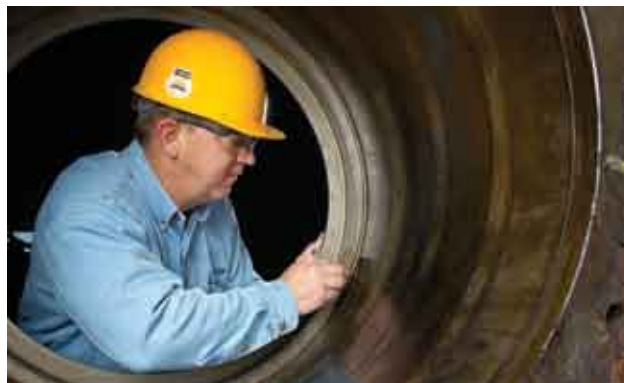
图 27 清除轴承座轴肩上所有刻痕与毛刺
