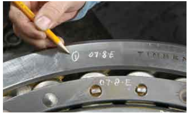
图31 轴承上标明外圈的四个等分区域
