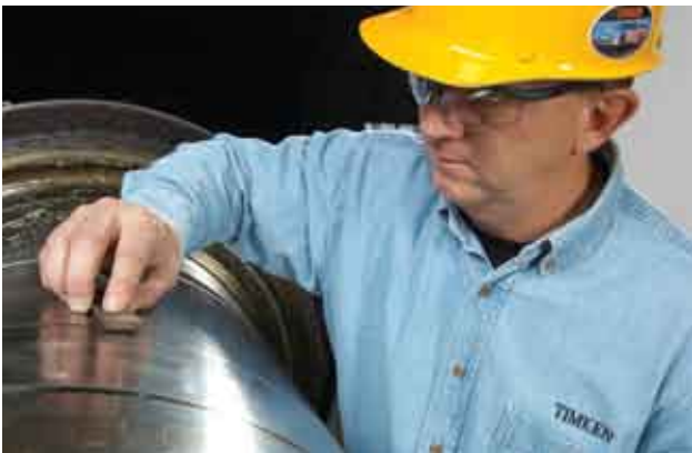
图42 去除轧辊颈上的所有刻痕
