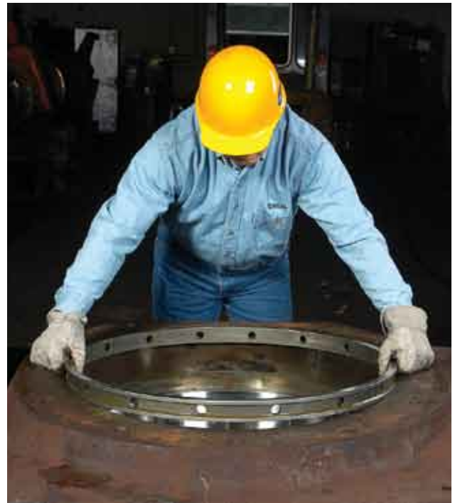
图37 将内圈隔圈和顶部外圈隔圈安装就位
