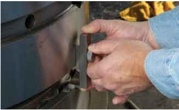
图19 测量B、D和C间隙以了解磨损程度
