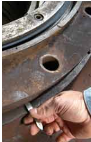
图40 使用塞规确保外圈被适当夹紧
