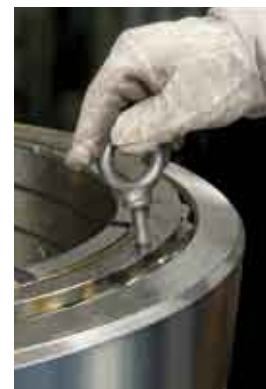
图6 在保持架环上备有吊装孔的TQO轴承
