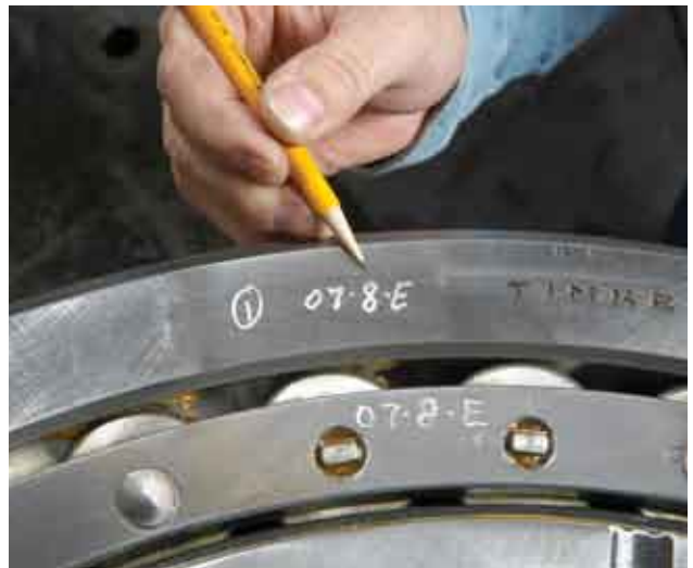
图15 遵照英文字母标记系统确保正确的叠放次序
