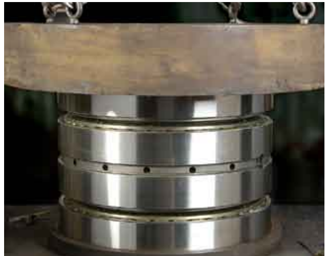
图14 施加重物以使轴承各部件适当地彼此贴合
