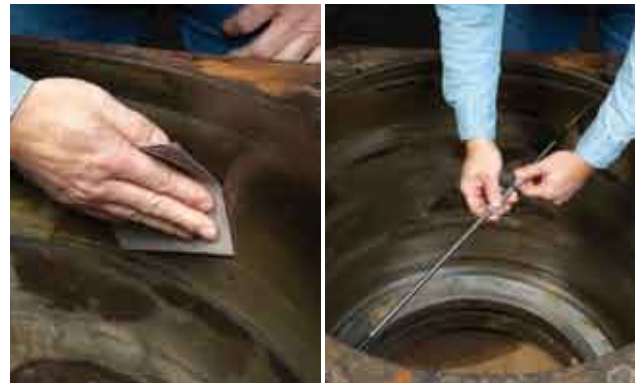
图23 除去轴承座上较严重的锈蚀或微磨损剥落 图24 检查轴承座内孔尺寸和不圆度
