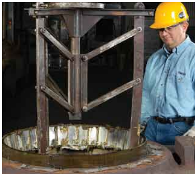
图10 取出底部单外圈和底部外圈隔圈
