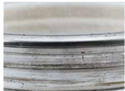
Danos na capa do rolamento (pista externa) causados por um ajuste com folga excessiva em um cubo giratório.
